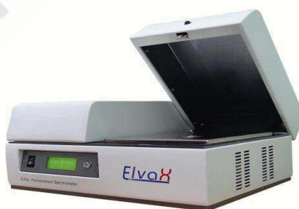
Рис. 2.5. Рентгено-флуоресцентный анализатор SER-01 (ElvaX, Украина)
