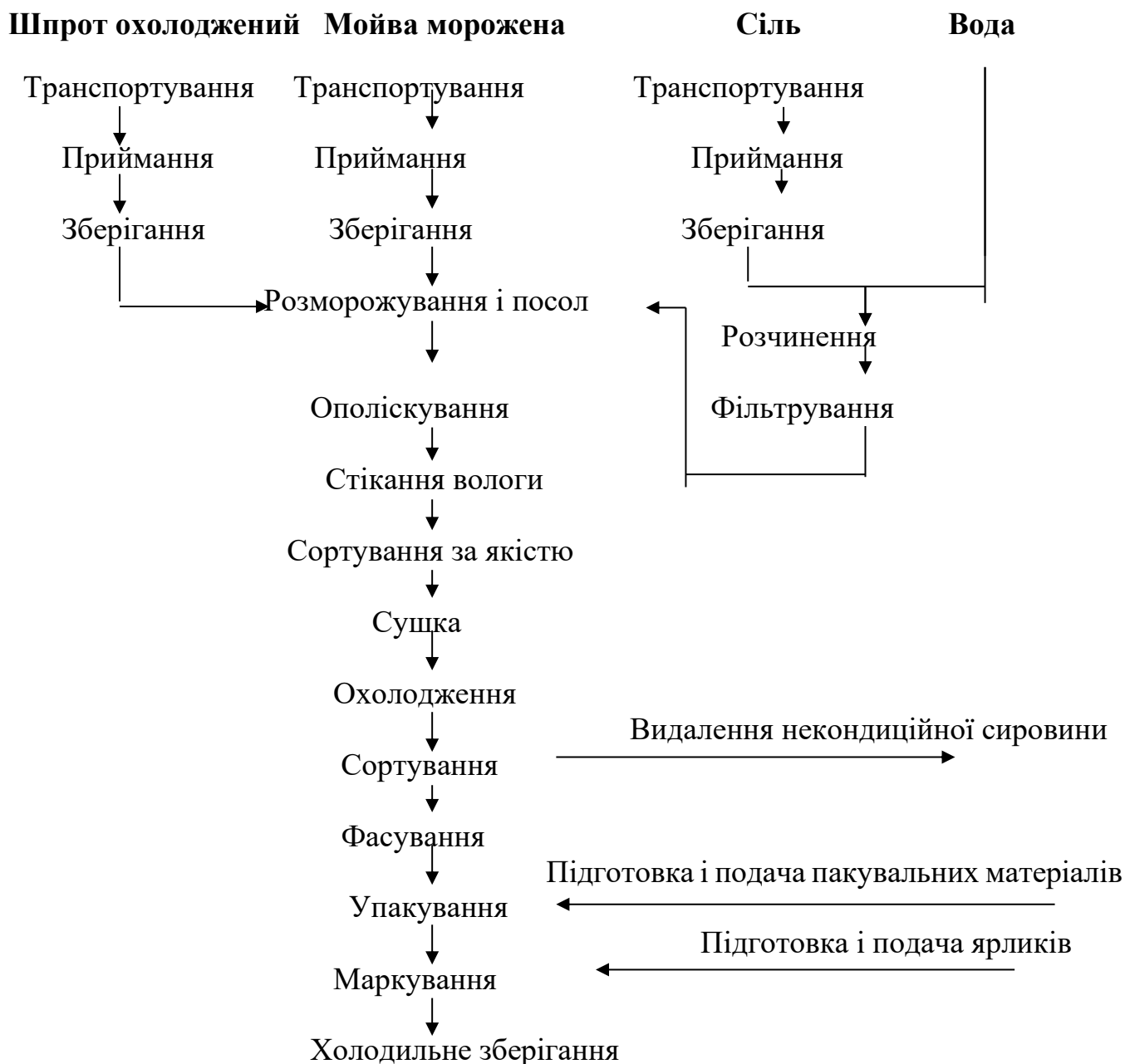
Рис. 3.3 - Технологічна схема виробництва «Сушеного рибного снеку з кі- льки чорноморської» та «Сушеного рибного снеку з мойви».
