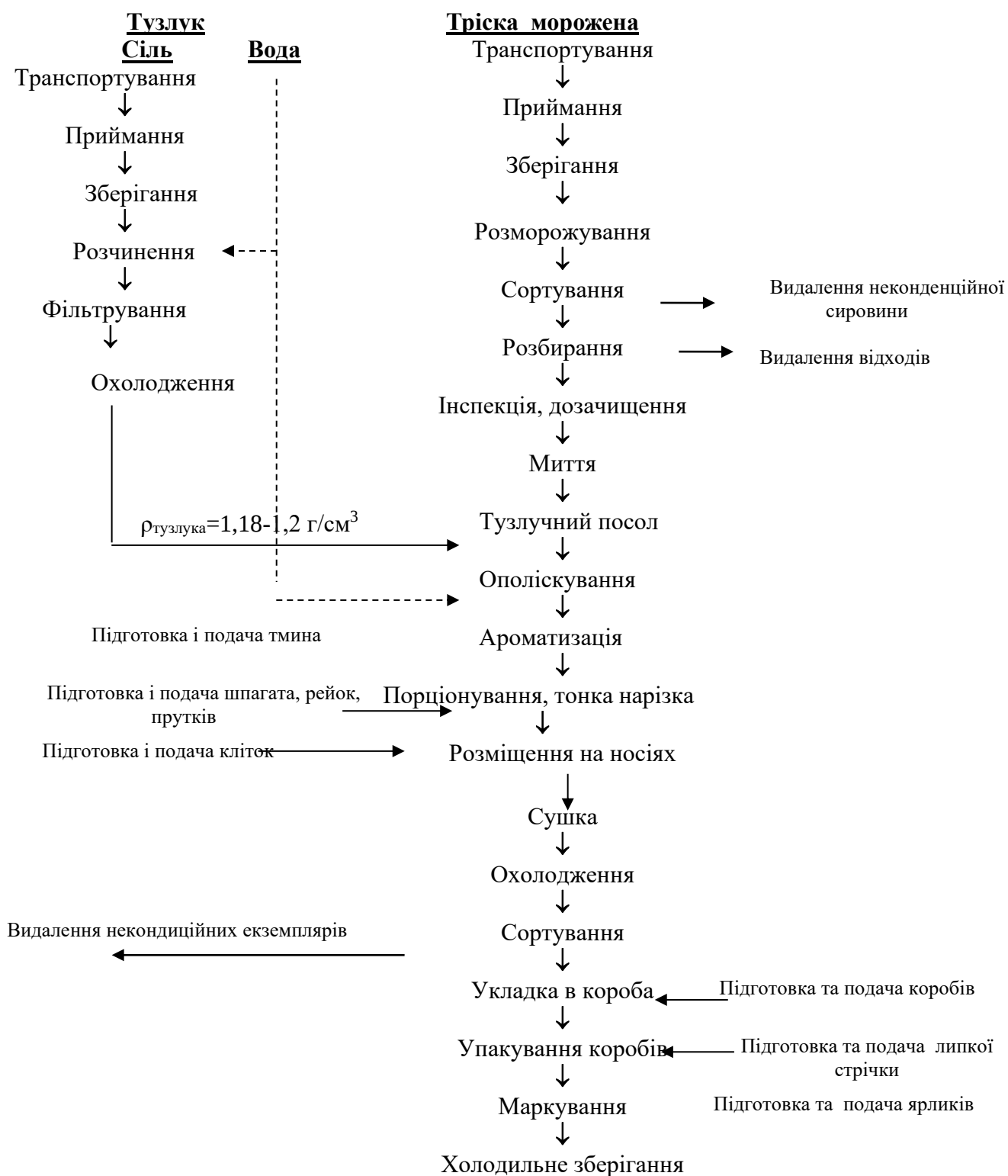
Рис. 3.2 - Технологічна схема виробництва «Рибного снеку «Курземський» з тріски (хека)»
