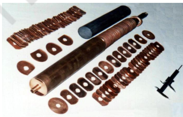
Рисунок 1. Модуль опытно-промышленного образца вымораживателя для извлечения тяжелых инертных газов.
