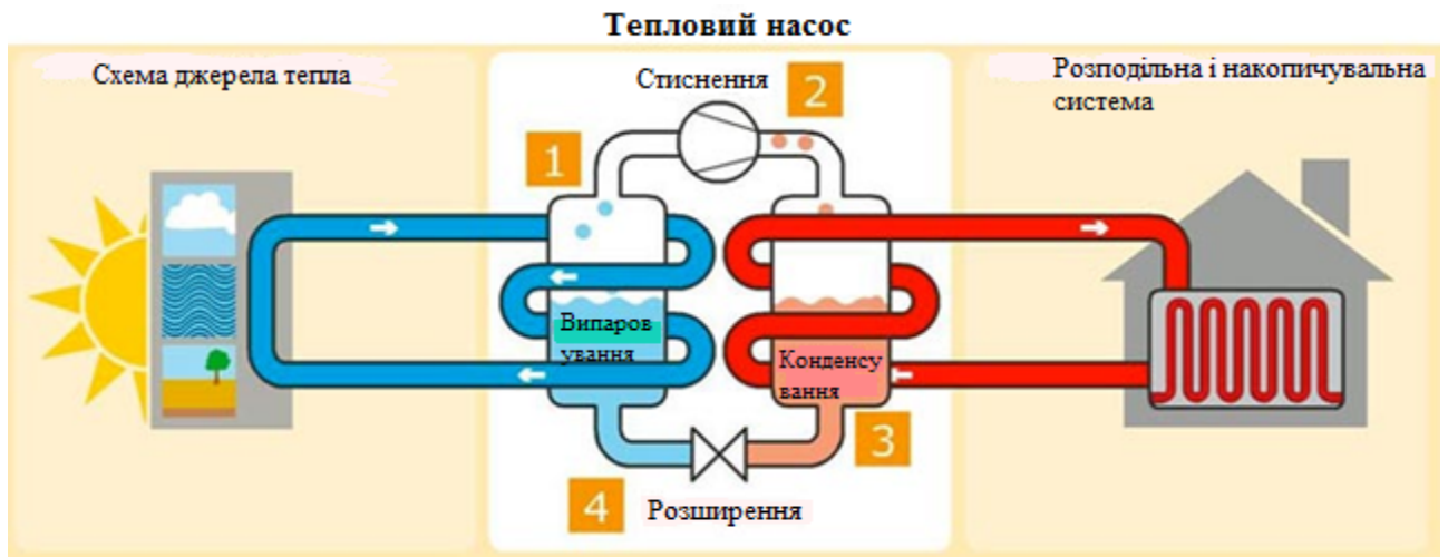
Рисунок 8. Схема роботи теплового насоса на базі ПКХМ
