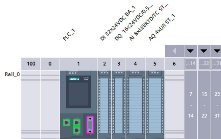
Рис. 5.34 – Апаратна конфігурація програмованого логічного контролера SIMATIC S7-1500
