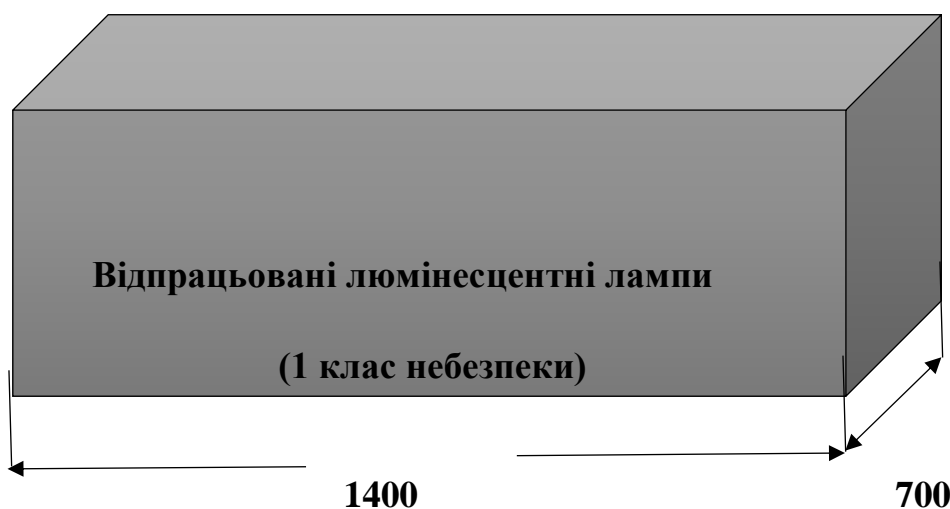
Рис. 2.1 - Ескіз контейнера для накопичення відпрацьованих люмінесцентних ламп
