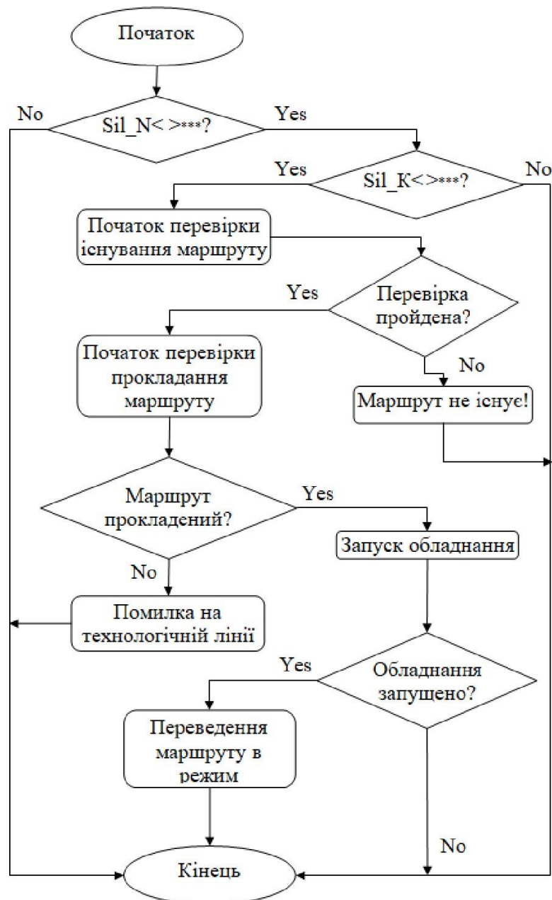
Рис. 3.3. Алгоритм автоматичного прокладання маршруту транспортування зерна у ТОВ «УКРЕЛЕВАТОРПРОМ»
