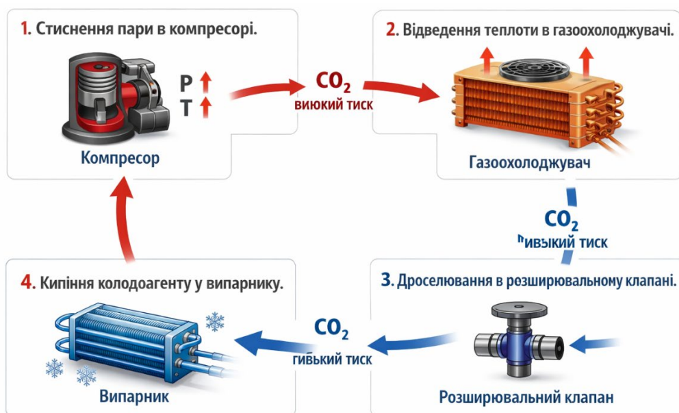
Рис. 1.1 Принцип дії ТН на CO 2 :
