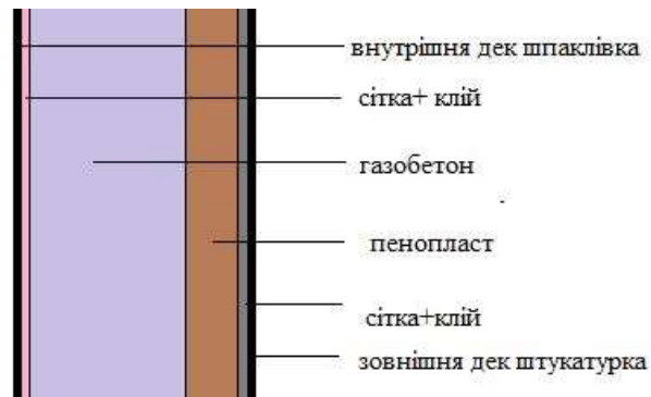
Рис.1. Схема розрізу огорожувальної конструкції
