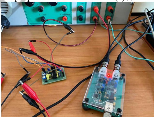
Рисунок 2 – Процес зняття частотних характеристик
