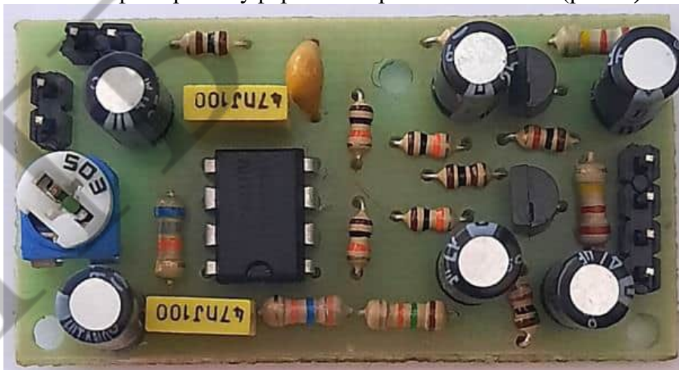
Рисунок 4 – Зовнішній вигляд фільтру сабвуфера на мікросхемі NE5532
