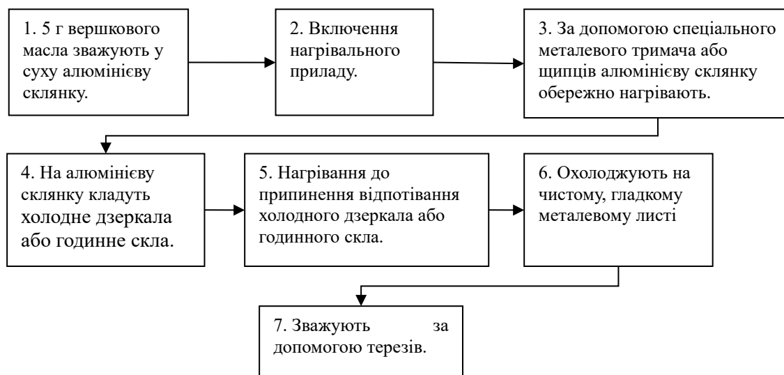
Рисунок 2.2 – Схема визначення масова частка вологи в маслі
