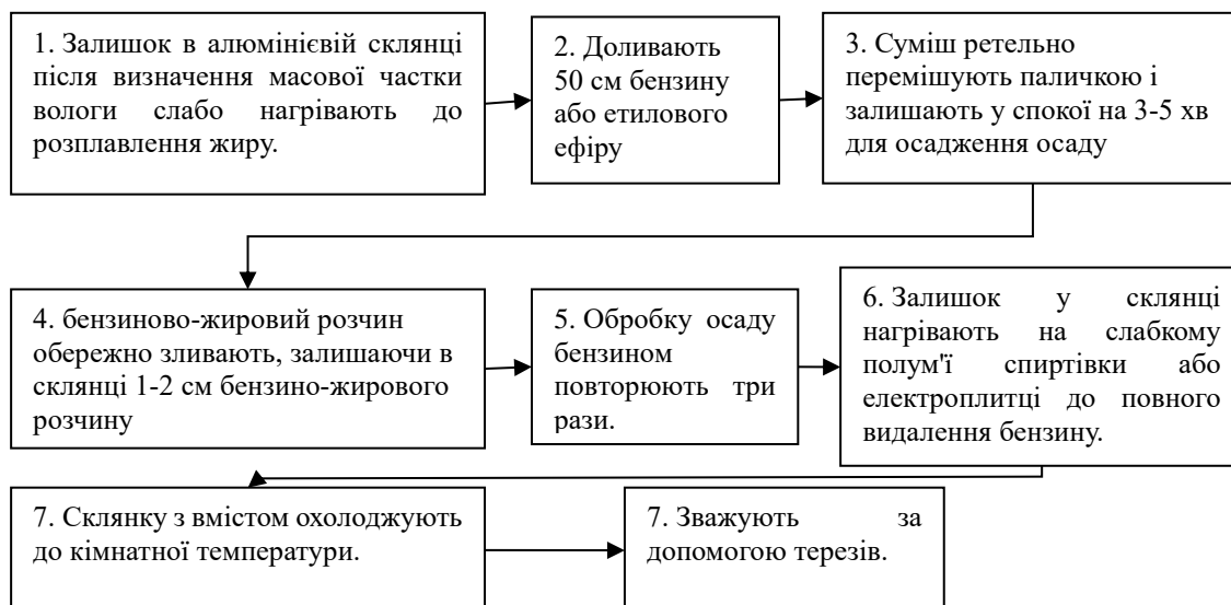
Рисунок 2.3 – Схема визначення масова частка знежиреної сухої речовини в маслі
