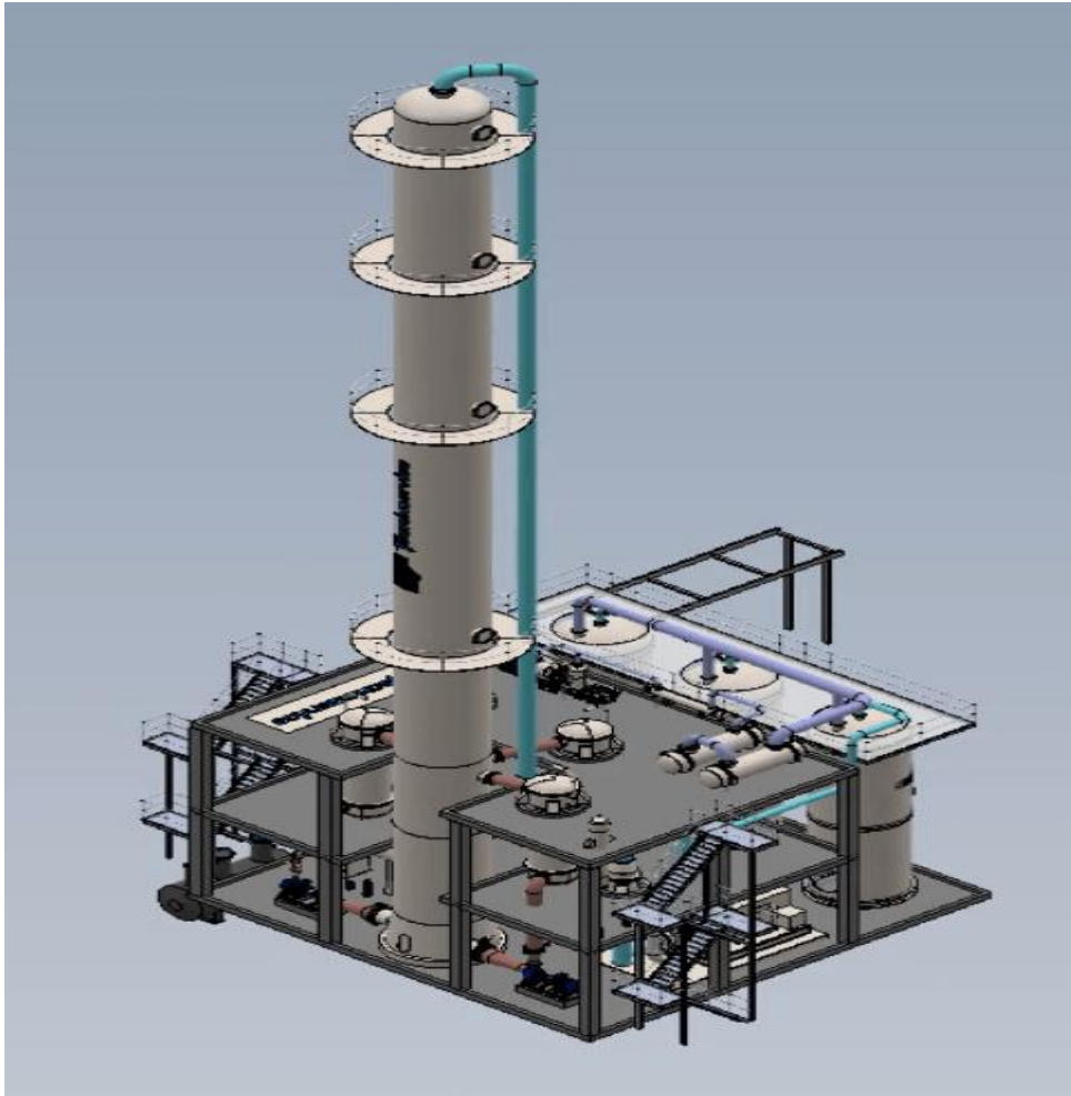
Рис. 3.1. Браго-ректифікаційна установка виробництва біоетанолу за технологією TEEU™
