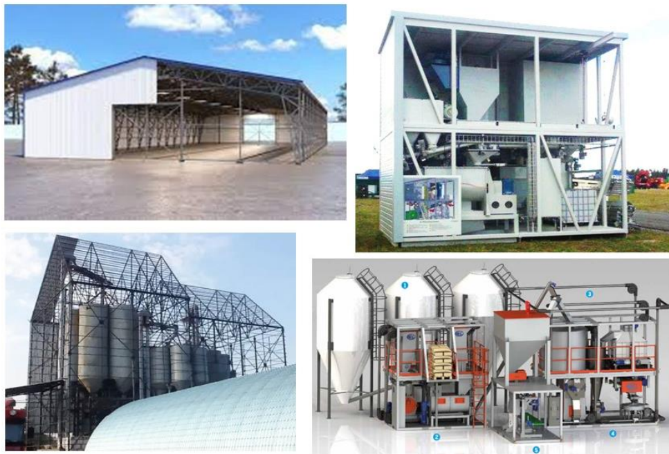
Рис. 8 – Принципи організації модульних установок для виробництва комбікормів за конструкцією
