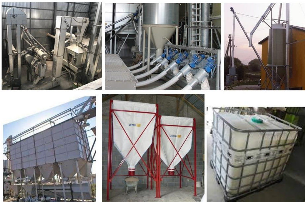
• Рис. 9 – Принципи організації модульних установок для виробництва комбікормів за комплектацією: транспортне обладнання, ємності для зберігання
