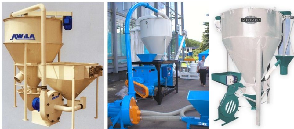
Рис. 3 - Міні-установки для виробництва комбікормів, продуктивність до 0,5 т/год бункер, пневмоприймач, дробарка, бункер-змішувач
