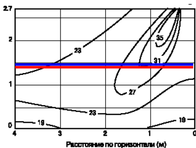
Рис. 3.2.5. Епюра температур повітря в припливній струмені касетного кондиціонера в режимі обігріву.
