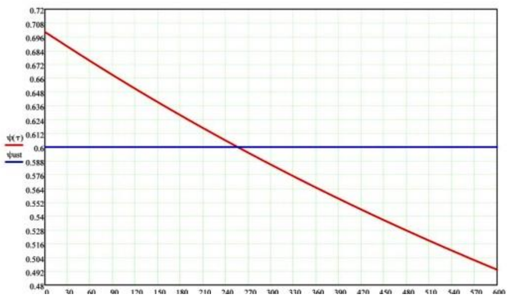
Рис. 1.3.3. Залежність відносної вологості в приміщенні з басейном від часу осушення повітря
