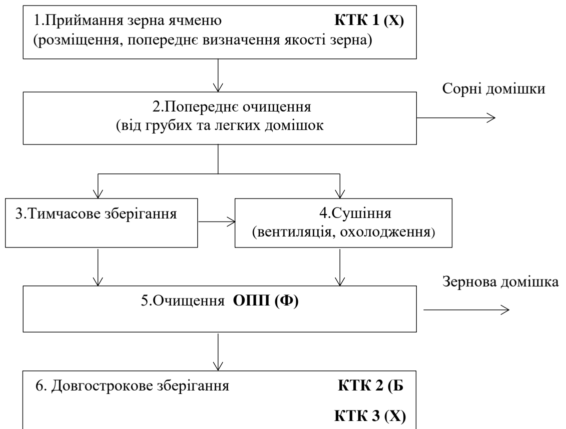
Рисунок 2.1 – Блок-схема технологічного процесу зберігання зерна ячменю продовольчого
