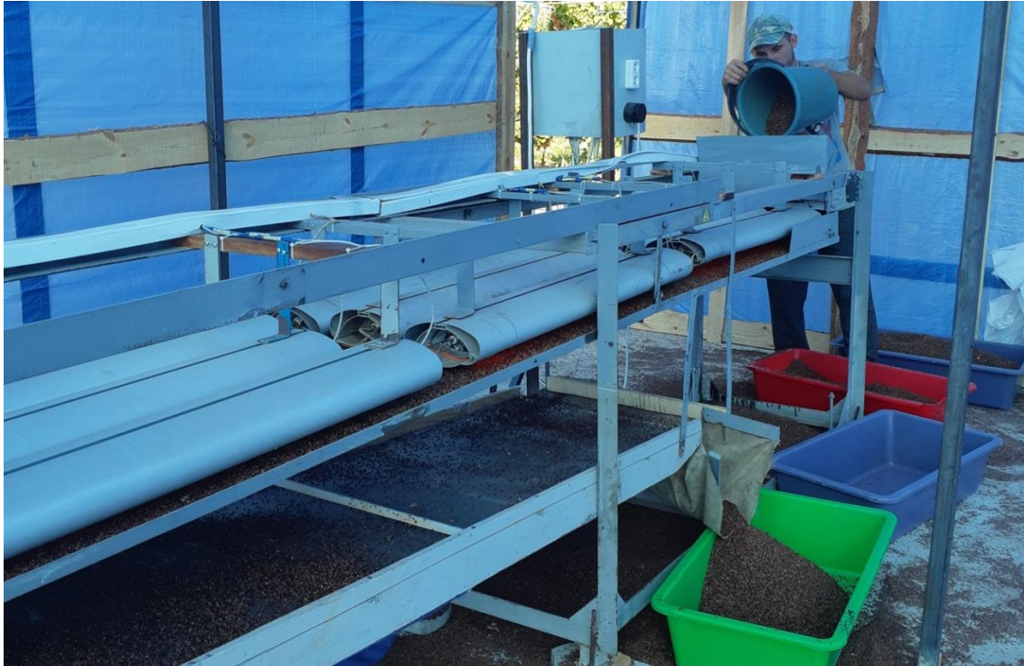
Рис.3 Инфракрасная сушилка ИКС-1 в работе
