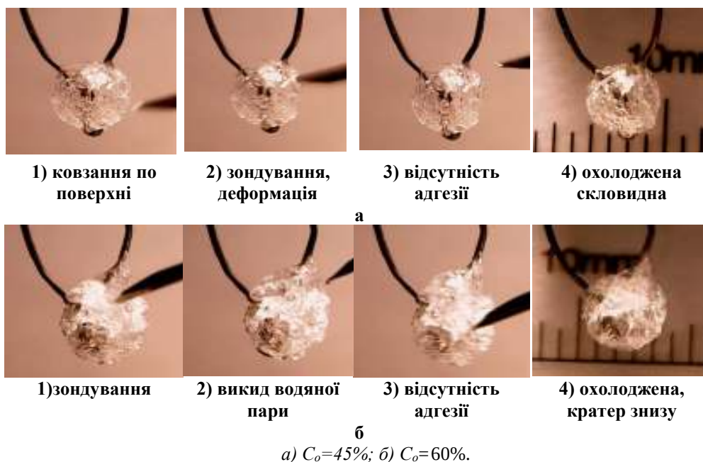
Рис. 7. Дослідження фізичного стану висушених часток ИГ-30, отриманих при температурі 140°C і концентрації розчину
