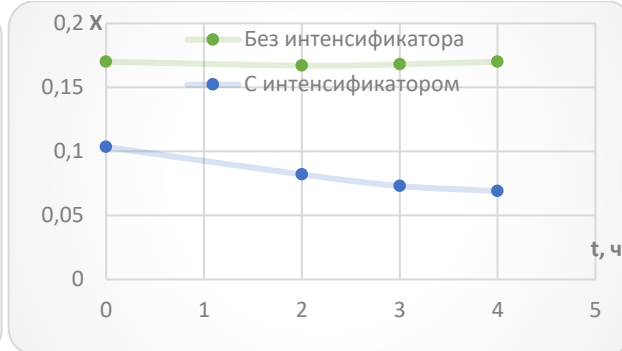
Рис. 9. Влияние ультразвукового интенсификатора на изменение концентрации соли в блоке льда с течением времени.
