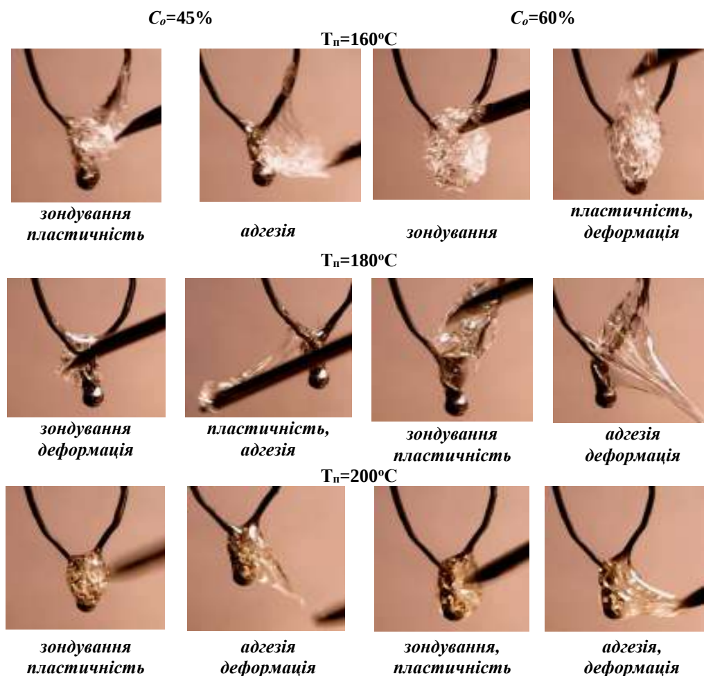
Рис. 8. Дослідження фізичного стану висушених часток ИГ-30 з концентрацією C_o=45\% і 60\% , отриманих при температурах теплоносія 160...200°C.
