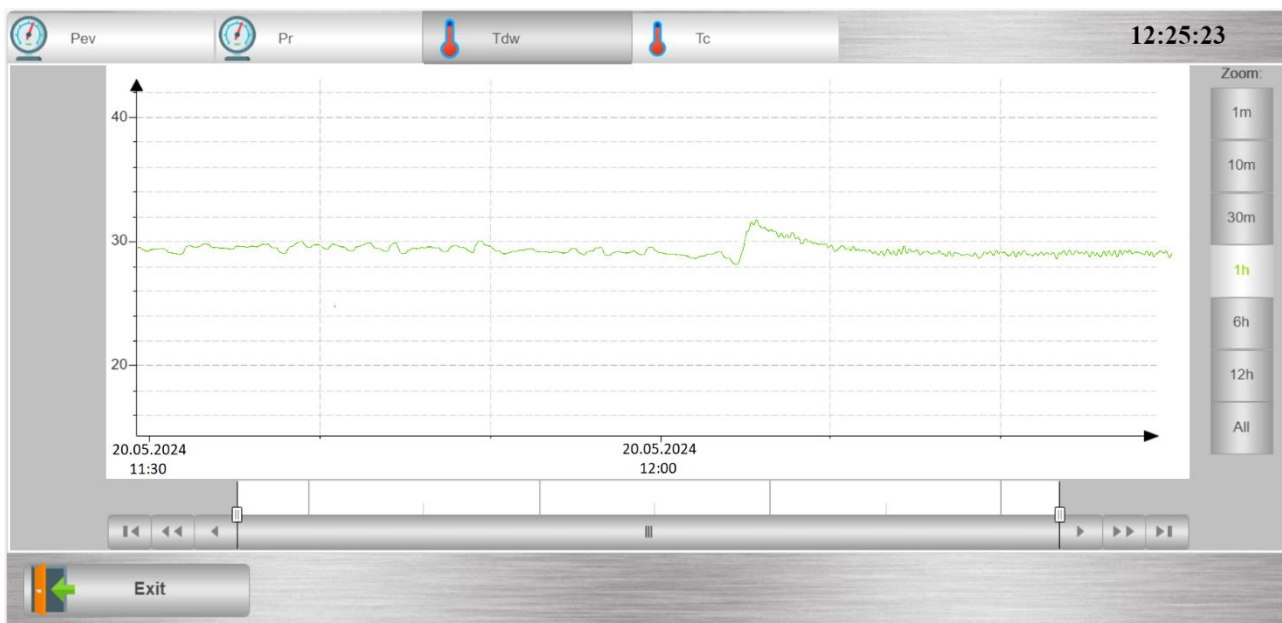
Рисунок 5.23 – Тестування веб-візуалізації вікна, що надає можливість перегляду графіку зміни температури на виході випарника
