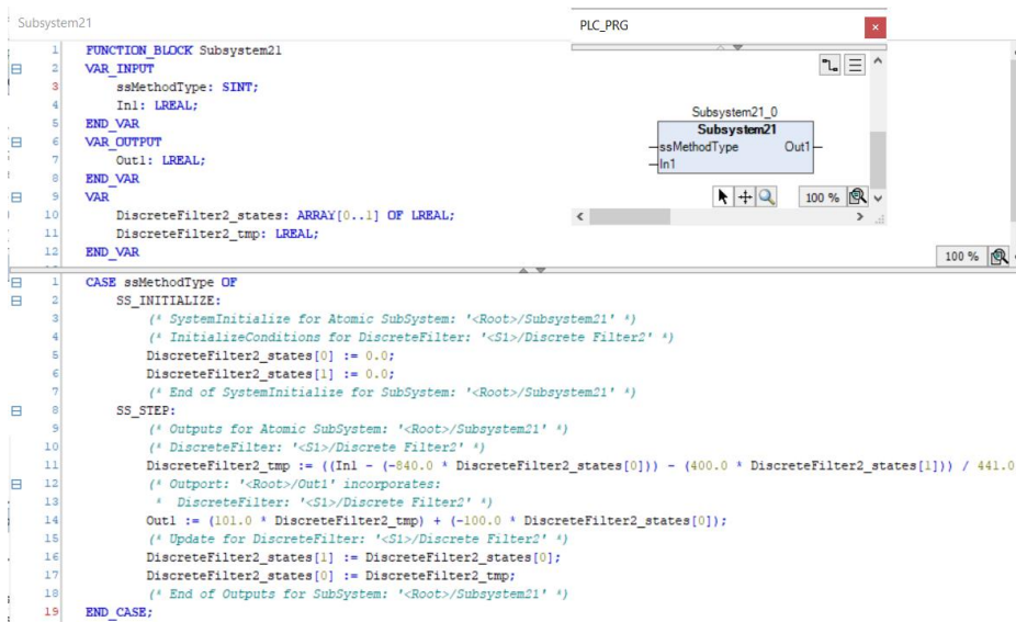
Рисунок 3 – Згенерований програмний код фільтра у вигляді функціонального блоку у виконавчому середовищі CoDeSys V3.5.
