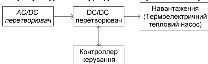
Рисунок 1 - Структурна схема потужного програмованого джерела струму для використання в системах керування термоелектричними тепловими насосами
