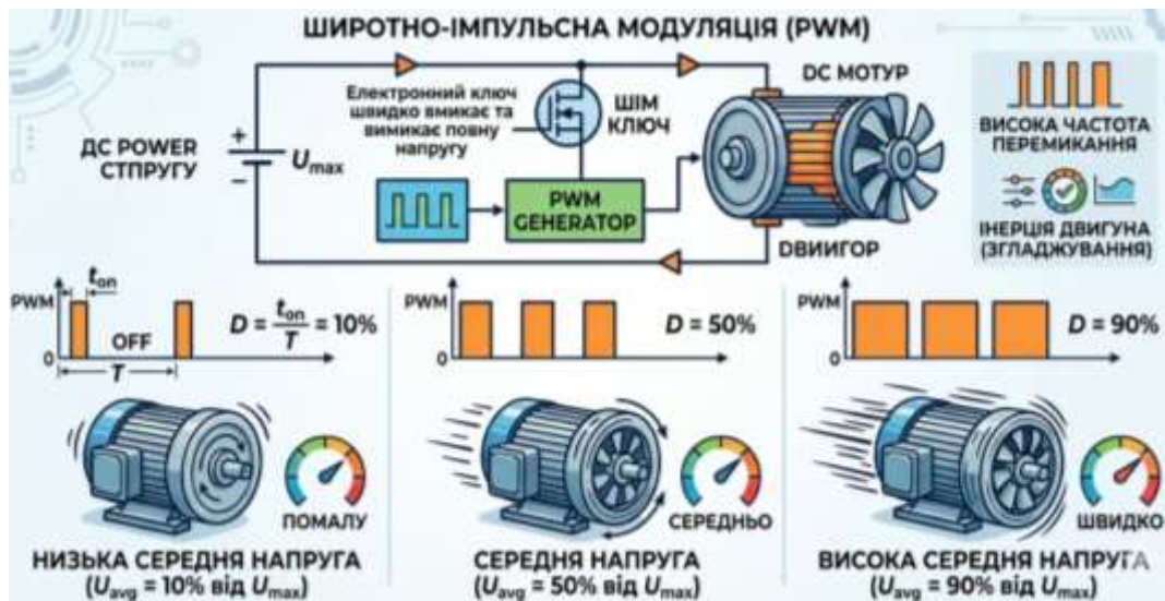
Рис. 2.1 Принцип ШІМ-регулювання напруги двигуна постійного струму
