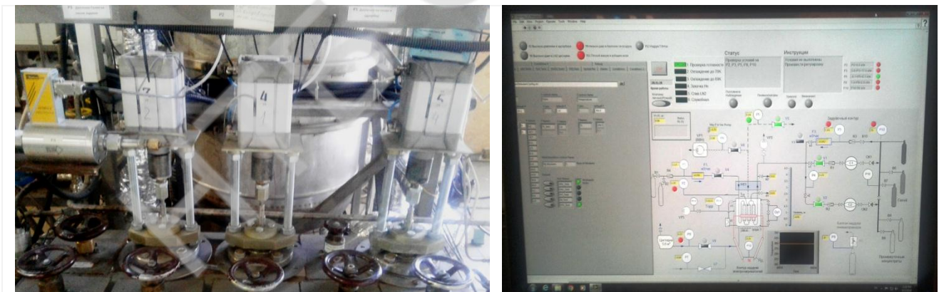
Рис.4. Блок пневмо керованих приводів криогенної арматури і інтерфейс оператора (праворуч).
