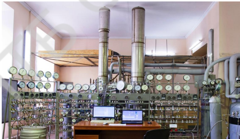
Рис. 3. Ступенева установка для вилучення стабільних ізоотопів неону
