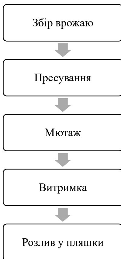
Схема. 4.1. Принципова технологічна схема виробництва кріпленого вина типу Піно де Шарант
