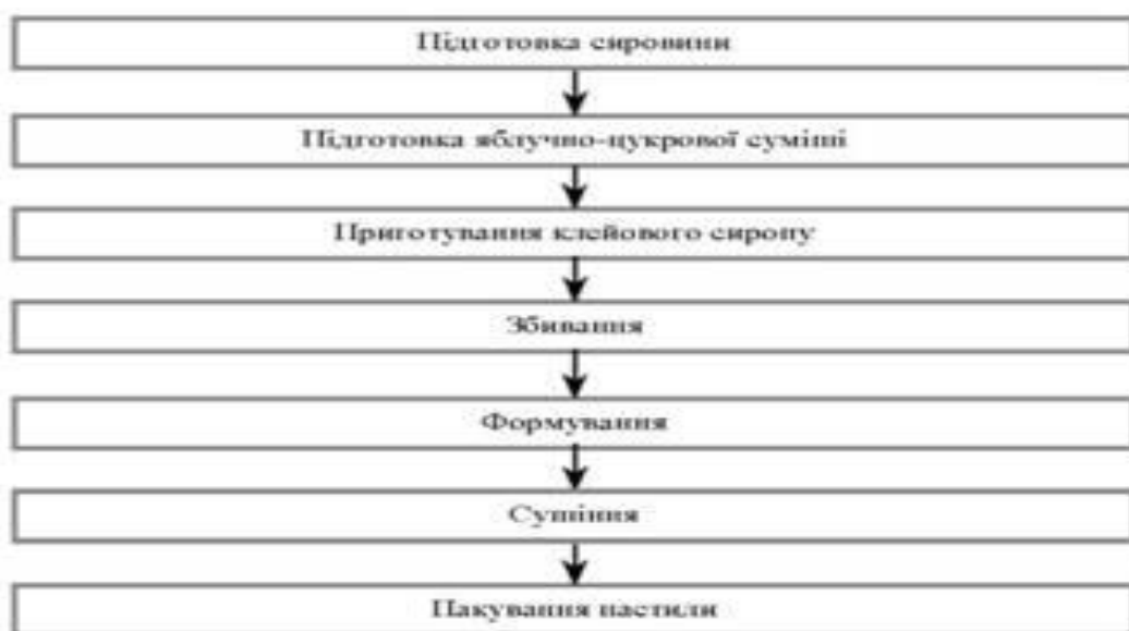
Рис.4. Функціональна схема виробництва пастили
