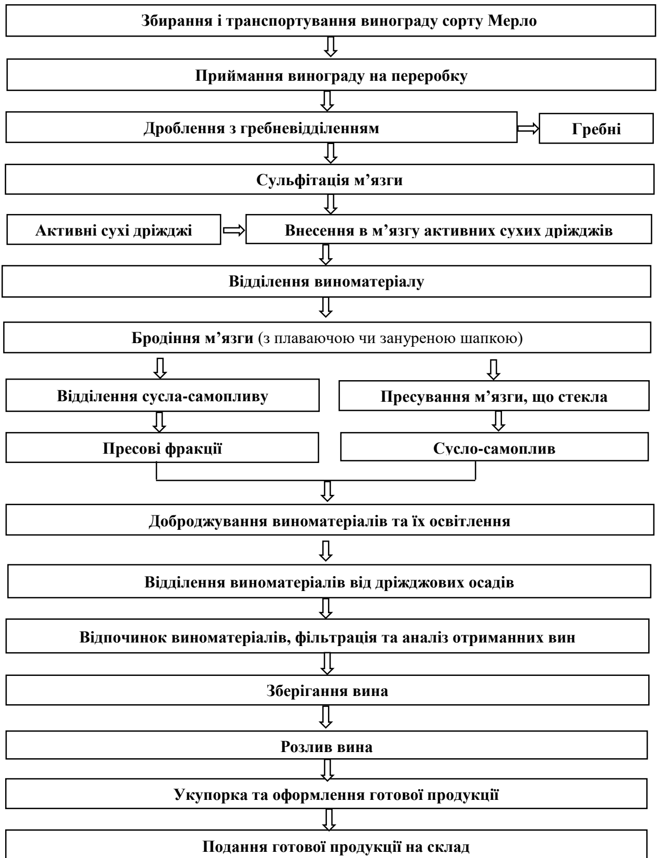
Рисунок 1.7 – Технологія виробництва червоних столових сухих сортових вин з винограду сорту Мерло [27]
