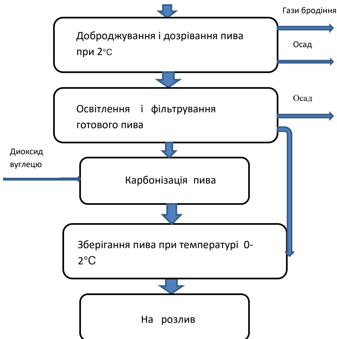
Рис. 1.4 Принципова технологічна схема виробництва пива
