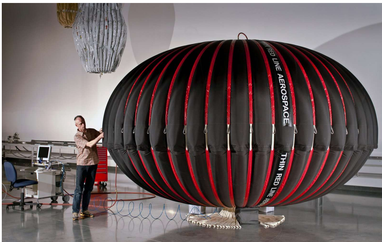
Рисунок 3.4.2-Головний інженер і генеральний директор Thin Red Line Aerospace Максим де Йонг перевіряє «енергетичний мішок» UW-CAES під час початкового випробувального надування
