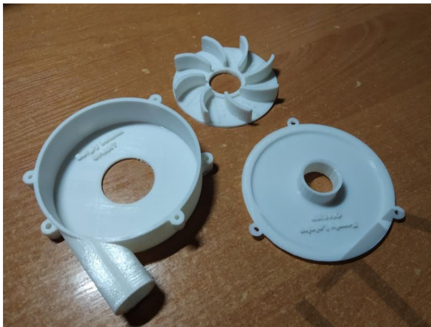
Рис.3 - Вид готової крильчатки, модель якої отримана за допомогою сканування
