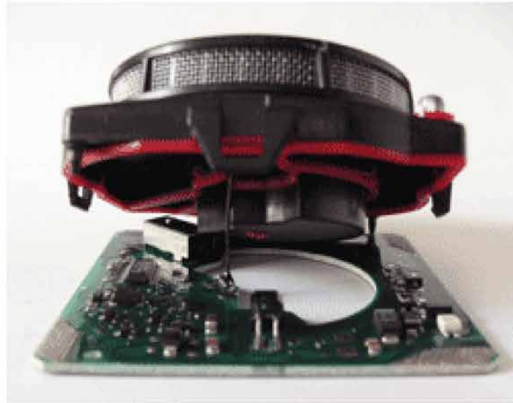
Рисунок 1.13. Герметизація друкованої плати
