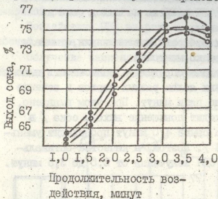
Рис. 4. Кинетика выхода сока из целых яблок разных сортов / монтер, семиренко и розмарин / воздействию СВЧ энергией. 1, 2, 3 — варианты при давлении до 2 МПа.
