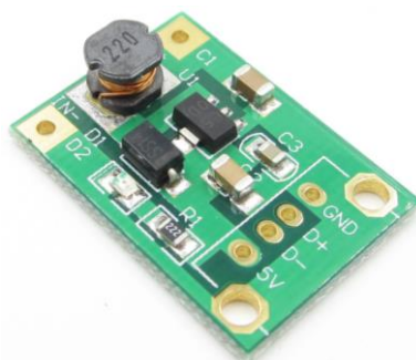
Рисунок 1.8 – Плата підвищення напруги до 5V
