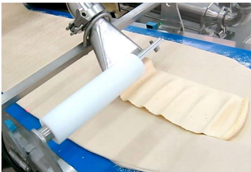
Рис. 2.3 Екструдер маргарина у лінії виробництва печива
