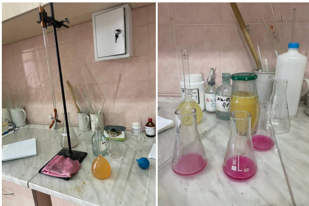
Рисунок 1.12 – Визначення титруємої кислотності
