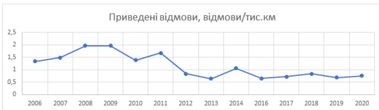
Рис. 3.8 – Розподіл відмов на об'єктах ГТС, спричинених корозійними процесами за період 2006-2016 рр.
