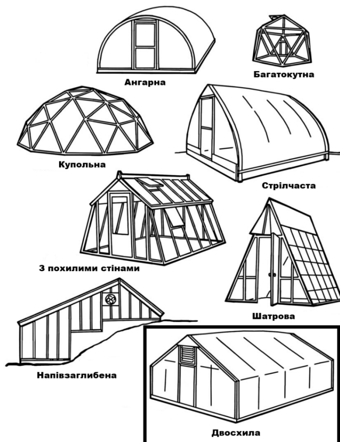
Рис. 1.1. Основні типи конструкцій сучасних фермерських теплиць ( https://fieldreport.caes.uga.edu/publications/B910/hobby-greenhouses/ )
