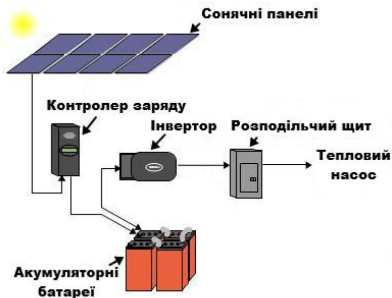
Рис. 1.3. Структурна схема автономної сонячної електростанції (Off-Grid)
