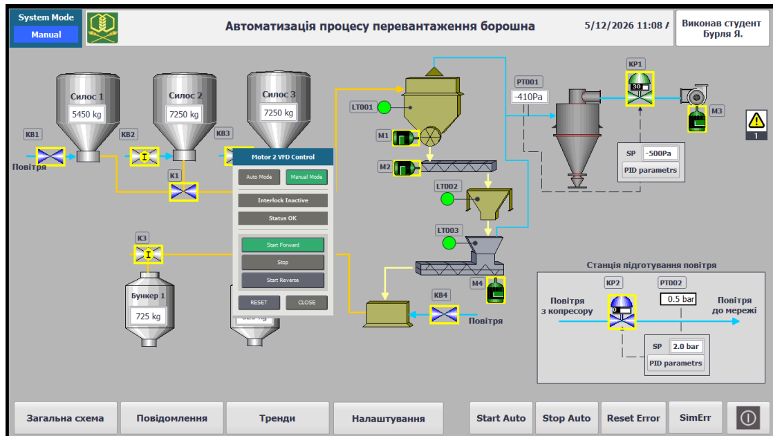
Рис. 7.15 Схема установки в ручному режимі.
