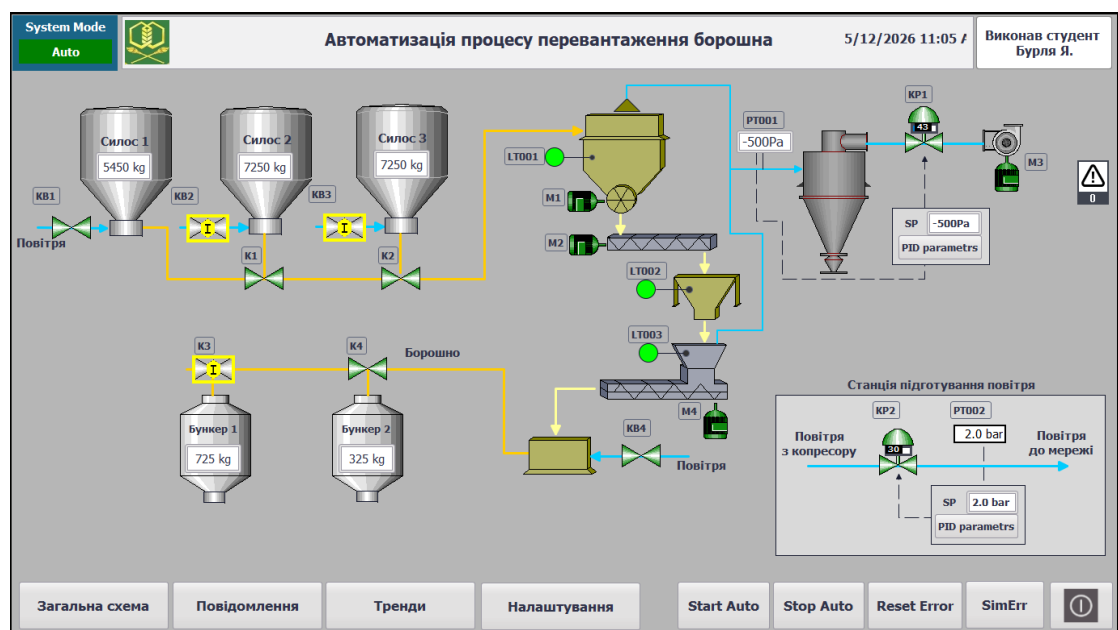
Рис. 7.16 Схема установки в автоматичному режимі.
