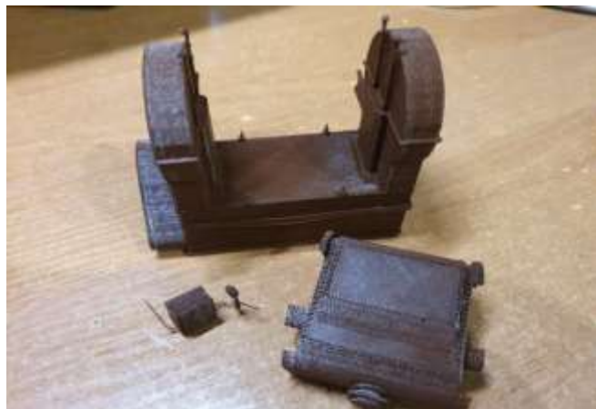
Рис.3.20 – Надруковані частини моделі тістомісу
