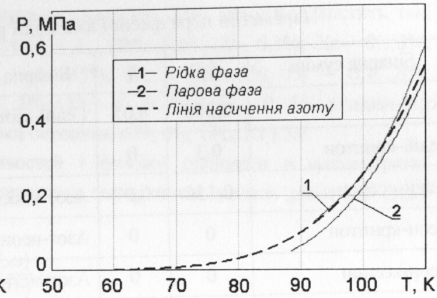
Рис. 4. Криві пружності пари компонентів модельної суміші Kr - Xe - O_2 - CH_4 - N_2
