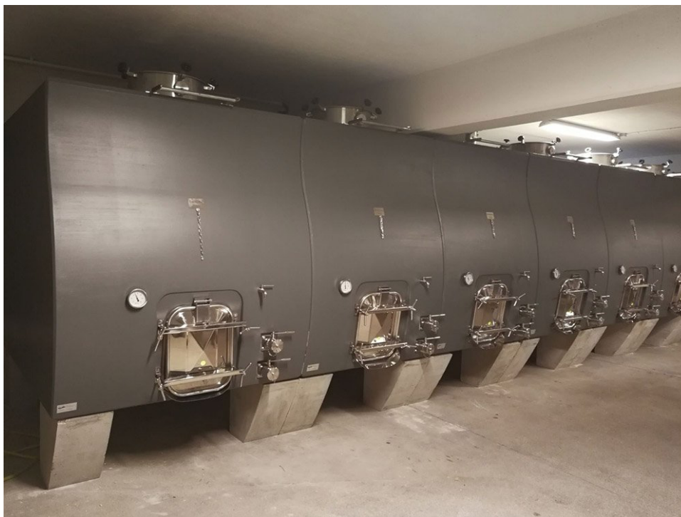
Рис. 1.5 — Витримка вина у ємностях з бетону
