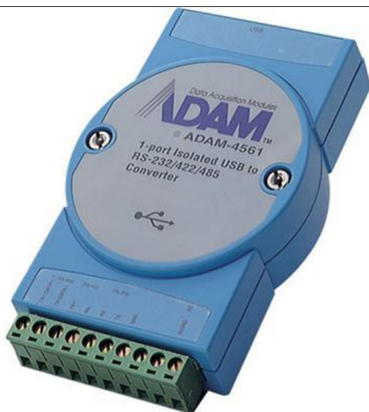
Рис 5.17. Модуль ADAM 4561 перетворювач інтерфейсів USB- RS485
