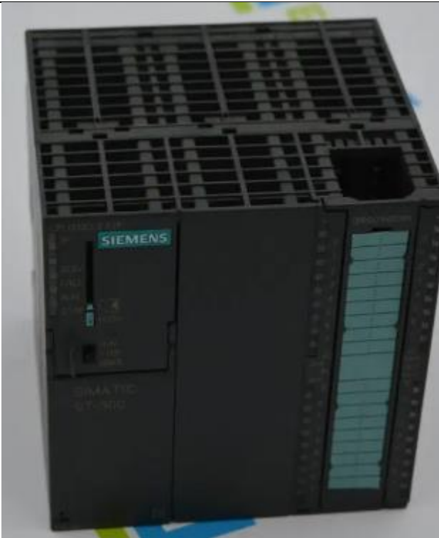
Рис 5.19. Контролер програмований SIMATIC S7-300, CPU313C-2DP
