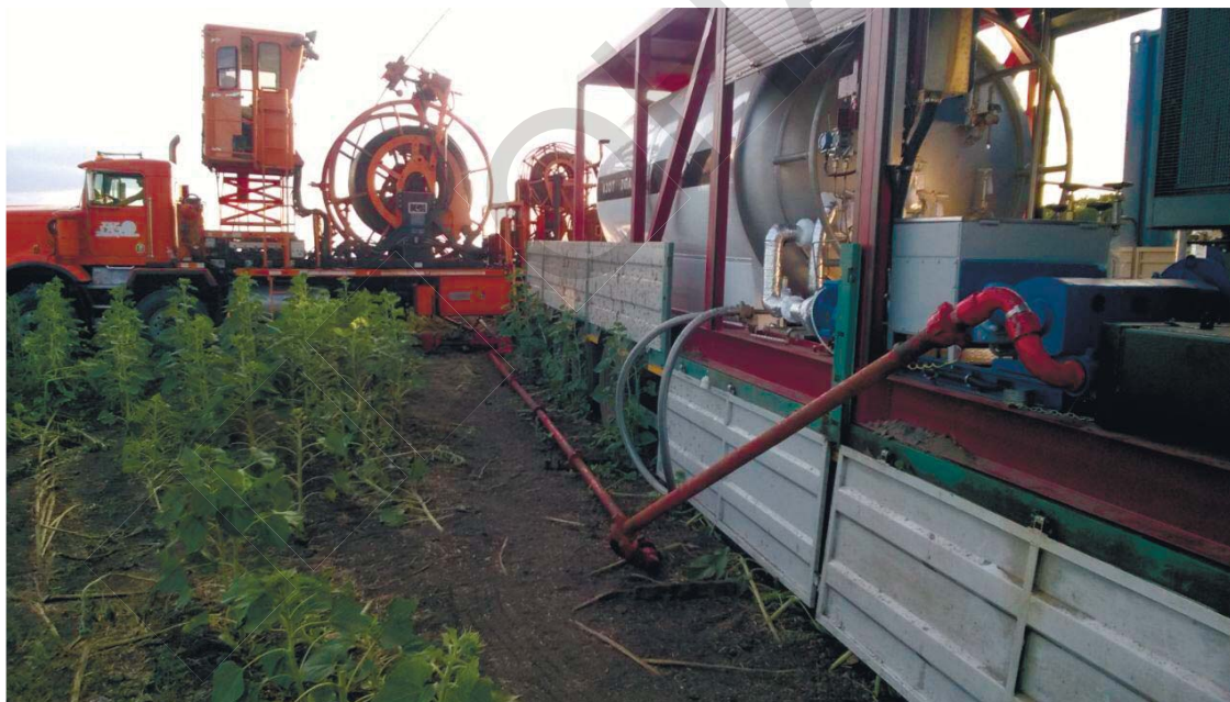
Рисунок 2. Газификационная азотная установка ГУ-600/45 в составе колтюбинговой установки
