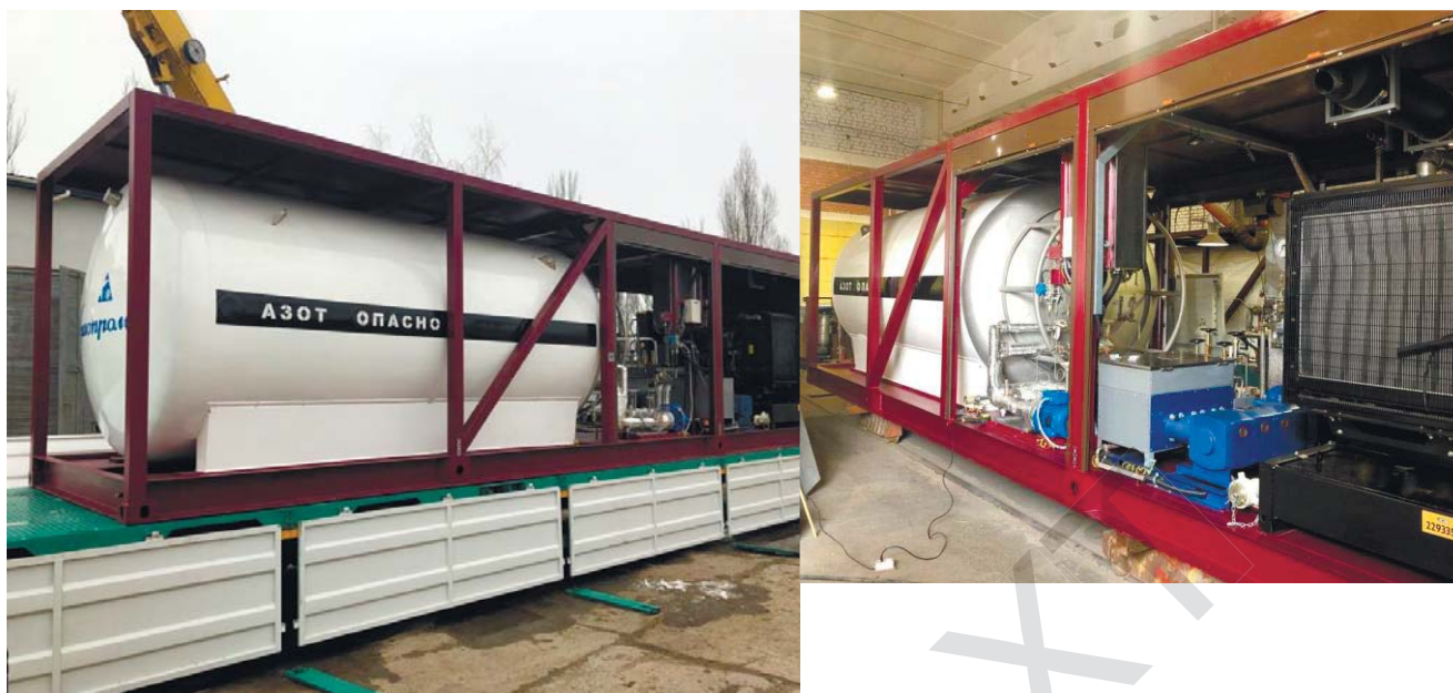
Рисунок 1. Газификационная установка ГУ-600/45
