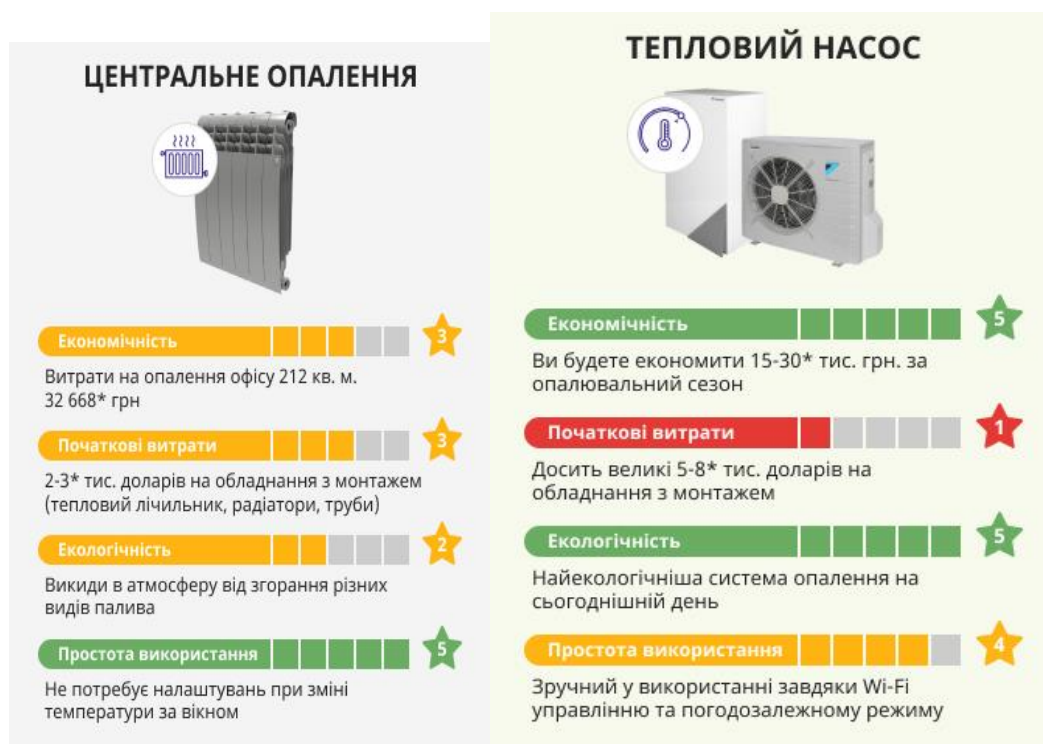
Рис. 9.1 Використання центрального опалення та теплового насоса
