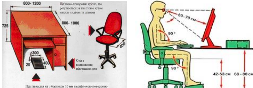
Рисунок 3.1 – Конструкція робочого місця, норми робочого простору
