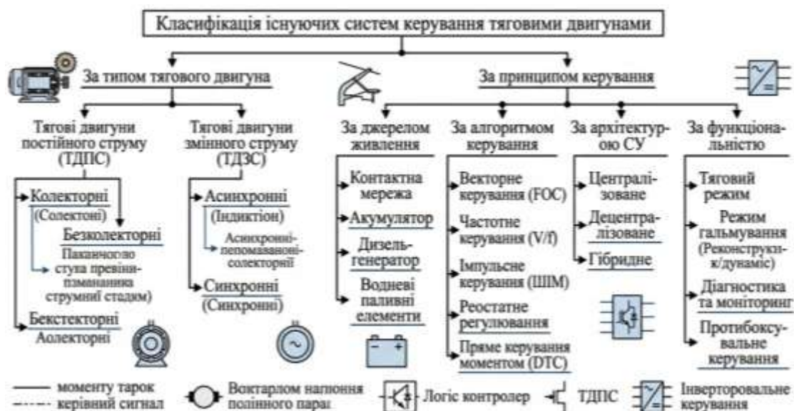
Рис. 2.4 – Класифікація існуючих систем керування тяговими двигунами
