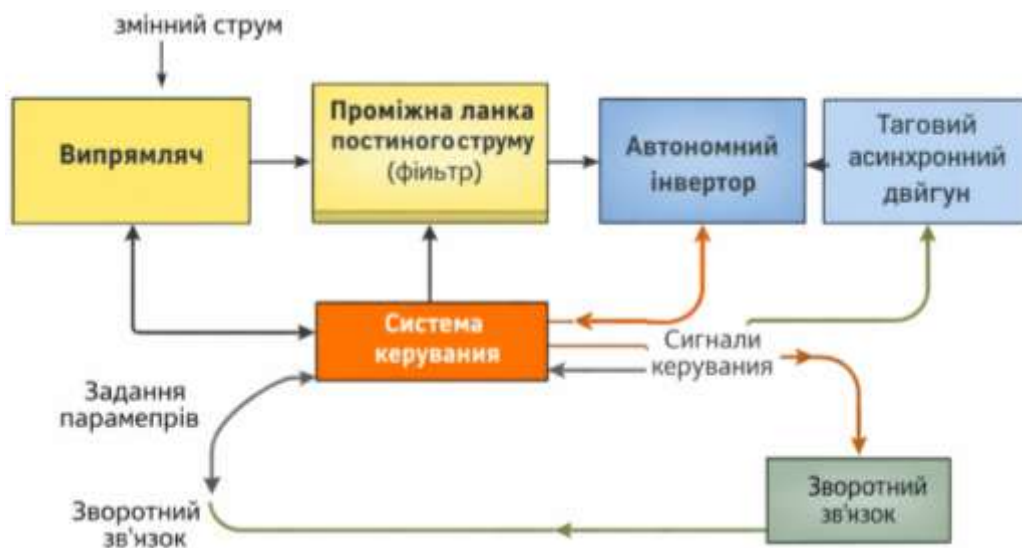
Рис. 2.2 – Функціональна схема силового перетворювача тягового електроприводу
