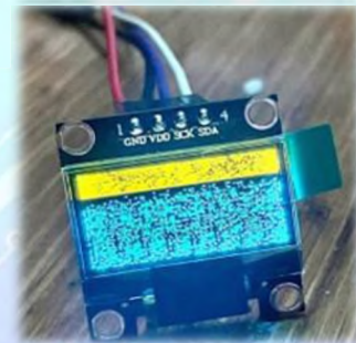
Некоректний вивід на OLED-дисплей SSD1306
