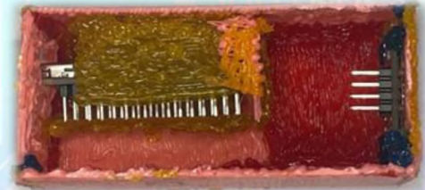
Початковий етап монтування корпусу пристрою
