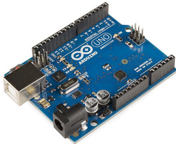
Рисунок 1.4. Приклад пристрою Arduino Uno
