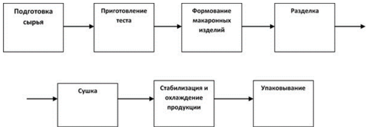
Рис.19 Технологія виробництва макаронних виробів
