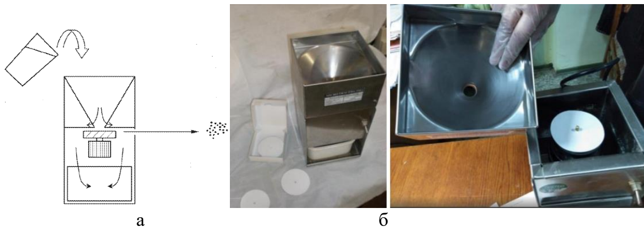
Рис. 2.2 - Обертальний детектор для вилучення мікротрейсерів із зразків комбікорму: а - спрощена схема вилучення мікротрейсерів за допомогою магніту, встановленого у роторному детекторі; б – типовий вид фільтрувального паперу з кольоровими плямами від двох відмінних за кольором мікротрейсерів.
