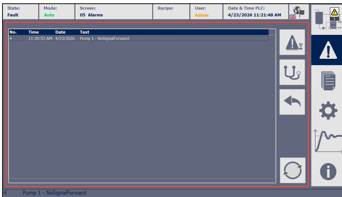
Рис. 7.19 – Екран Alarms в тестовому режимі при імітації несправності обладнання (насосу молока) лінії приймання молока.
