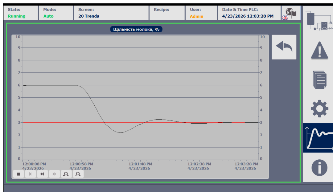
Рис. 7.18 – Екрани «20 TRENDS» та «21 TRENDS» з відображенням температури та щільності молока в тестовому режимі.
