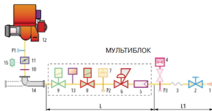
Рис. 1.4 Схема приєднання пальника до газової мережі
