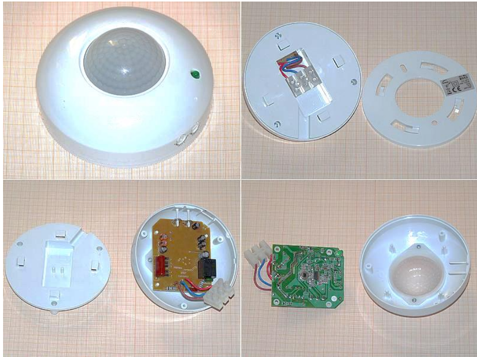
Рисунок 1.8 Інфрачервоний датчик руху
