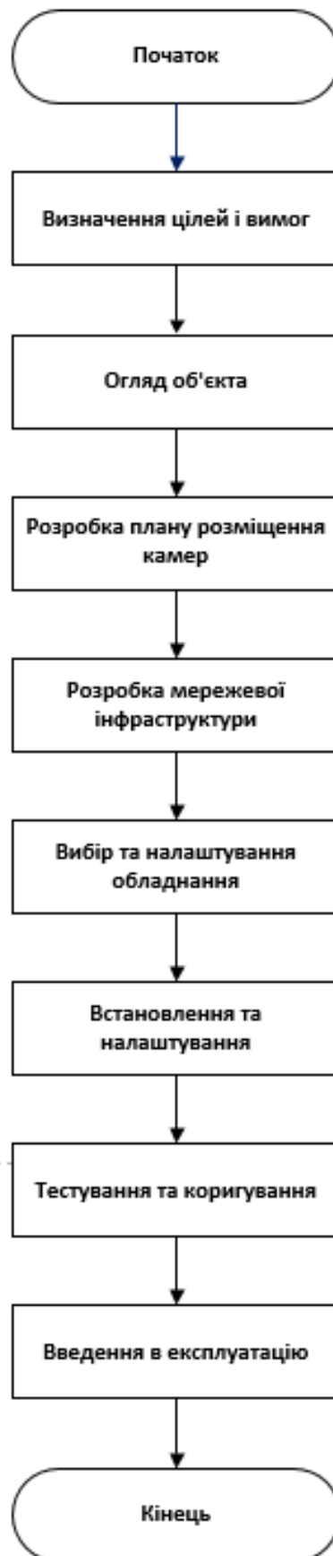
Рисунок 1.4. Блок сема алгоритму проектування системи IP-відеоспостереження
