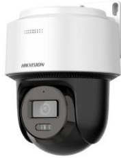
Рисунок 1.8. Hikvision DS-2DE2C400MWG-E 4 МП Smart Hybrid Light Mini PT мережева камера
