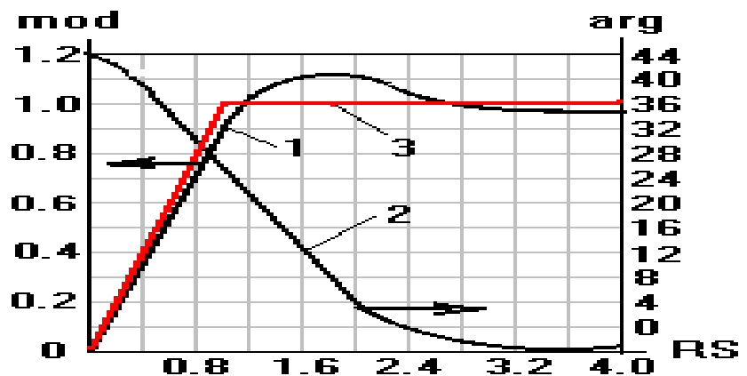
Рис. 4 Графік зміни модуля ( 1) і аргументу (2) функції \text{th}(R S \sqrt{i}) і наближена залежність (3), в інженерному методі.
