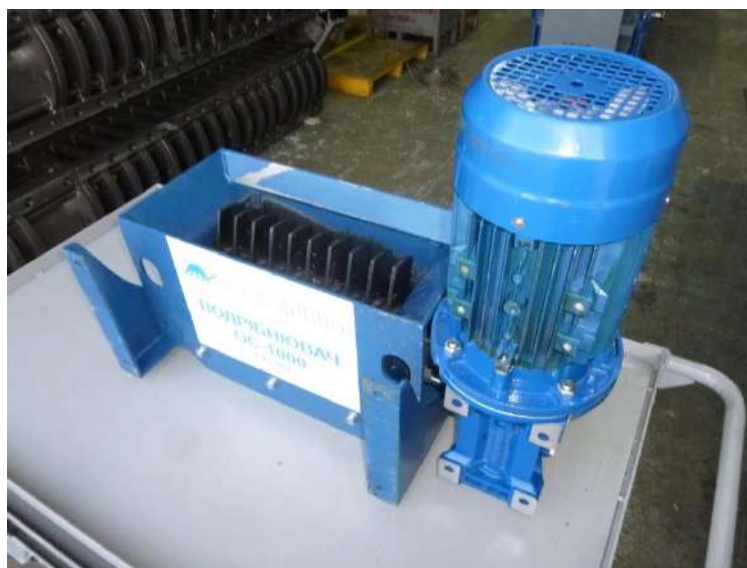
Рисунок 20 – Подрібнювач макухи ОС-1000
