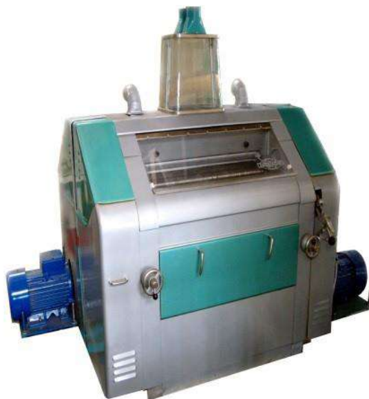
Рисунок 14 – Вальцевий станок ВС-5
