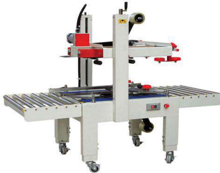
Рисунок 26 – Автомат для обандеролювання картонних ящиків
